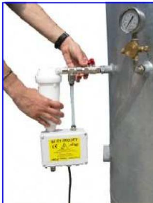
Scollegare, se collegato, il connettore spina-presa (10) presente all'estremità del cavo del livellostato.
