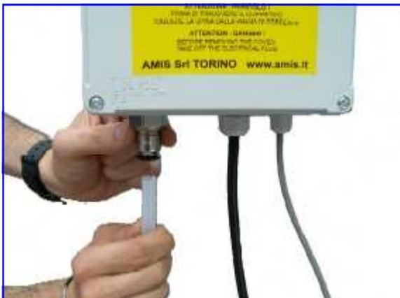
Inserire un'estremità del tubo in Rilsan (4) nel raccordo ad innesto rapido presente sul fondo della scatola elettrica di ELETTROJET.
